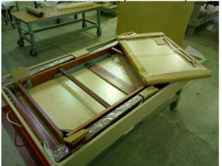
4. Снять блокировку с шариковых направляющих при помощи стопора.
