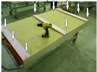
2. При помощи отвертки отрыть фанеру, которая закреплена на скобы, и убрать в сторону во избежании травмирования и повреждения изделия. Выкрутить саморезы (4шт), которые держат вставку.
