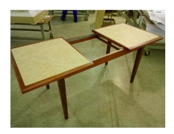
9. Установить вставку стола и зафиксировать шариковые направляющие при помощи стопоров (смотри пункт 4).
